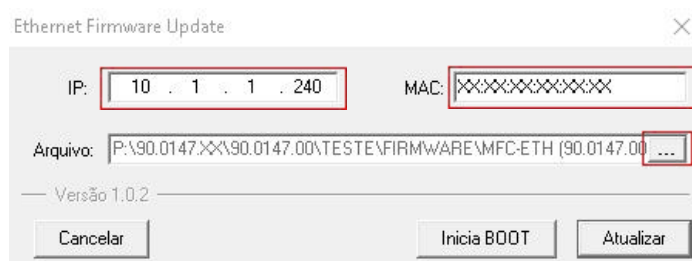
Figura 16 - Exemplo de atualização de firmware via Ethernet.
