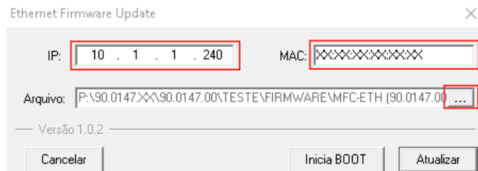
Figura 24 - Exemplo de atualização de firmware via ethernet.
